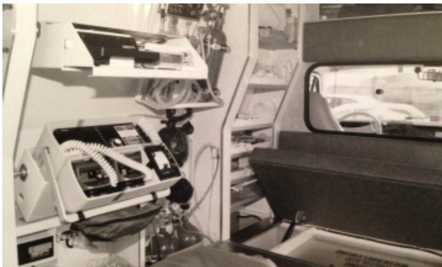
Der Defi noch ein eher flaches Gerät und vor allem Equipment zur Beatmung: So sah es vor zwei Jahrzehnten in einem RTW aus. (Bild: Ambulanz Murten)
